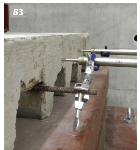
Εικόνα 6: Ρηγμάτωση και ακραία ολίσθηση στην αστοχία που καταγράφηκαν κατά τον πειραματικό έλεγχο των δοκιμών σειράς Β. Σύμμικτες πλάκες B1 (α), B2 (β) και B3 (γ).
