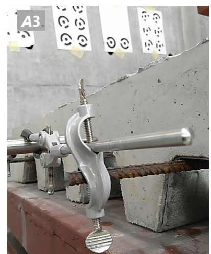
Εικόνα 5: Ρηγμάτωση και ακραία ολίσθηση στην αστοχία που καταγράφηκαν κατά τον πειραματικό έλεγχο των δοκιμών σειράς Α. Σύμμικτες πλάκες Α1 (α), Α2 (β) και Α3 (γ).
